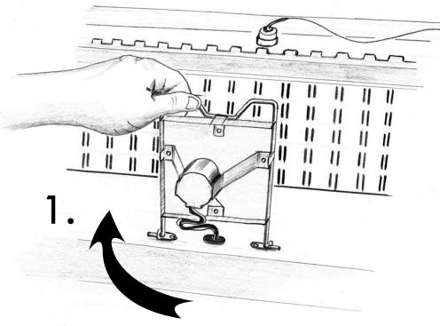
Ouvrez le couvercle de l'appareil et soulevez (1) l'humidificateur.
