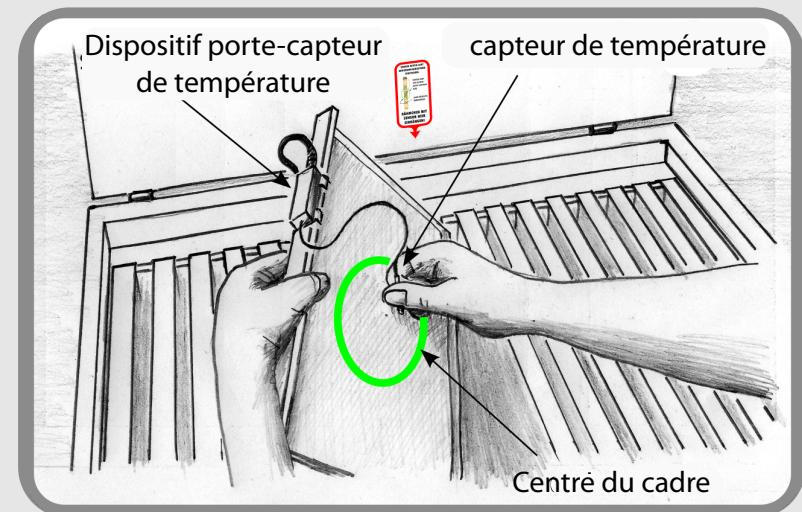
**VEILLEZ à ce que la sonde soit correctement posée et que la partie métallique ne sorte à aucun endroit. Elle doit être entièrement entourée de couvain et au centre du cadre.**
