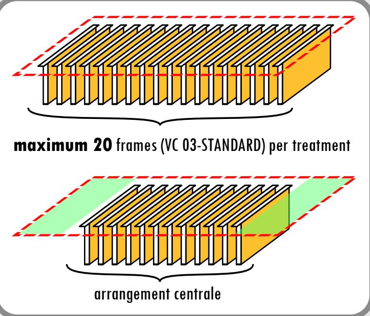
Maintenant les cadres à traiter peuvent être placés dans le Varroa Controller. Ouvrez le couvercle du Varroa Controller et accrochez un cadre après l'autre dans la chambre de traitement, en commençant par le bord de la machine.
