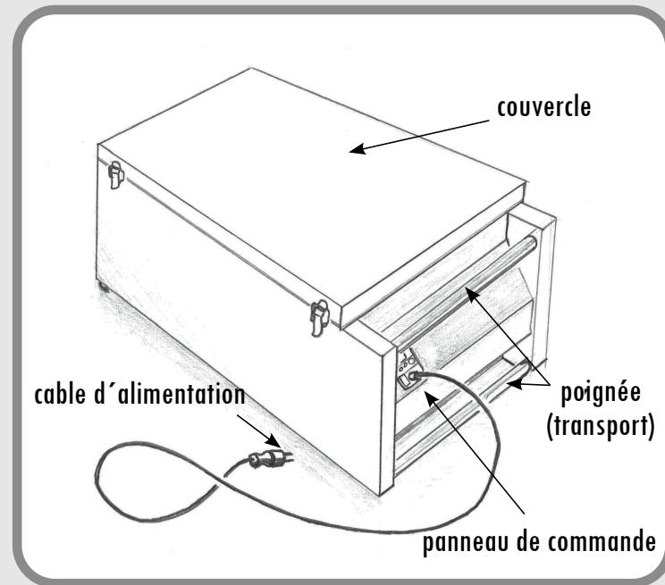
Le Varroa Controller possède deux éléments opérationnels:
